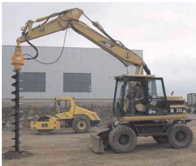
AD1100 acoplada a excavadora
